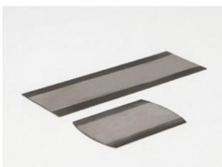
Zum planen Abziehen von Füllstoffen von befüllten Schäden sowie zum Entfernen von Lacknasen und -pickeln in der Lackoberfläche. Hochwertiger Stahl, gehärtete und geschärfte Schnittkanten. Lackziehklinge, klein: speziell zum „Herausziehen“ von Kratzern in weißen PVC-Fensterrahmen, besonders gut geeignet für schwer zugängliche Stellen.
